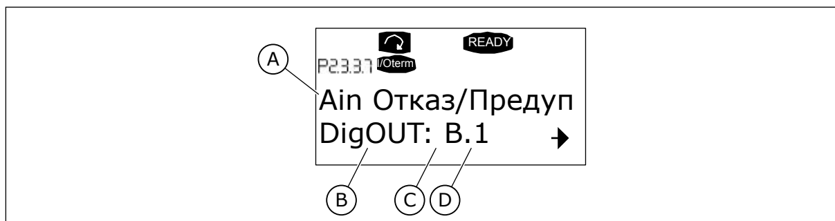
Рис. 94: Определение входа/выхода для некоторой функции на клавиатуре
