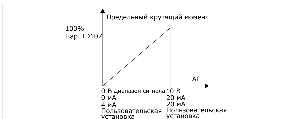
Рис. 50: Масштабирование максимального тока двигателя
