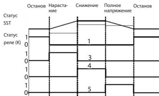
Статус выхода нескольких реле
